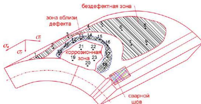
Рисунок 1 – Внешний вид дефекта и точки контроля
