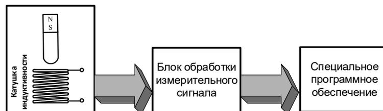
Рисунок 1 – Структурная схема экспериментальной установки регистрации процесса ударного нагружения
