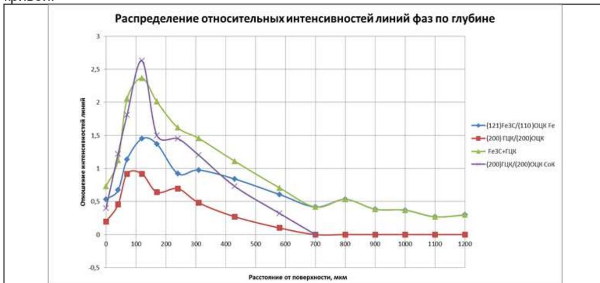
Рисунок 4 - Результаты послойного рентгенофазового анализа закаленного образца
