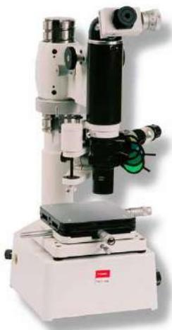
Рисунок 2 – Внешний вид микротвердометра ПМТ-3М
